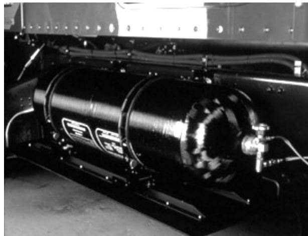
Flüssigwasserstoff-Tank unter dem Prototyp eines Freightliner-LKW Foto: Freightliner
