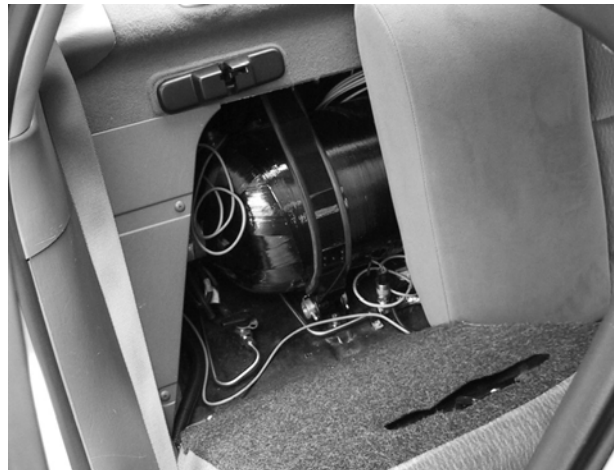
Blick auf die teilweise umgeklappte Rückbank und den Tank des Wasserstoff-Focus
