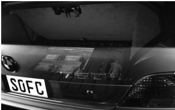
BMW ersetzt die Autobatterie durch die Brennstoffzelle Foto: BMW
