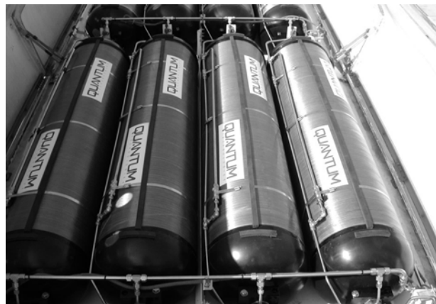
Drucktanks für Wasserstoff unter 350 bar auf einem Busdach Foto: Quantum
