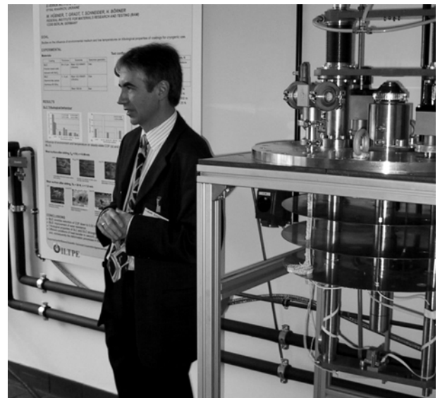
Dr. Gradt mit einem der Probeneinsätze für sein Flüssig-Wasserstoff-Tribometer Foto: DWV
