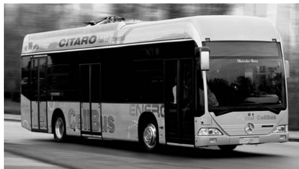
Prototyp der Citaro-Serie mit Brennstoffzellen auf Testfahrt in Kanada Foto: DaimlerChrysler
