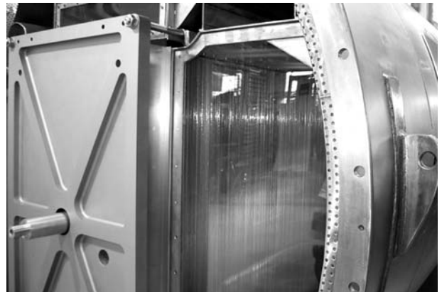
Der Stack einer Schmelzkarbonat-Brennstoffzelle (MTU)
