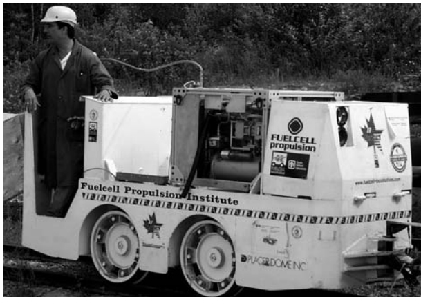
Kein Hindernis in Sicht? Die Wasserstoff-Grubenlokomotive bei der Erprobung. Foto: Fuelcell Propulsion Inst.
