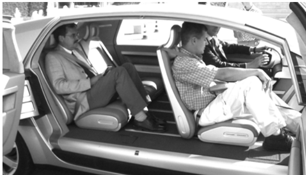
Einsteigen, bitte: keine Säulen, kein Tunnel behindern die Passagiere
