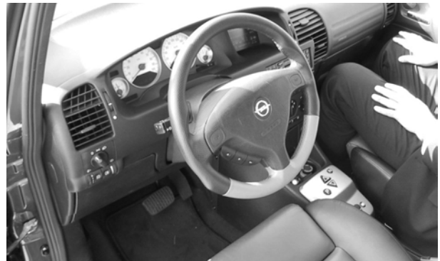
Wo ist der Schaltknüppel? Im HydroGen 3 ist nur noch ein Wahlknopf für vor/zurück Foto: DWV
