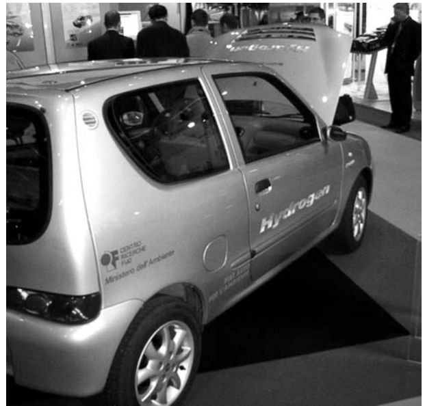
Das Auto ist ein Fiat 600, die Brennstoffzelle kommt von Nuvera
