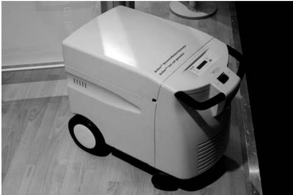
Diesen Kleingenerator von Ballard auf Basis des Nexa-Moduls vertreibt heliocentris Foto: DWV
