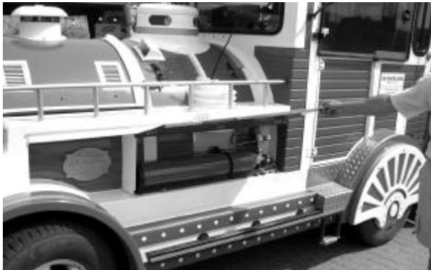
Der Wasserstoff-Vorrat wird in einer Gasflasche mitgeführt
