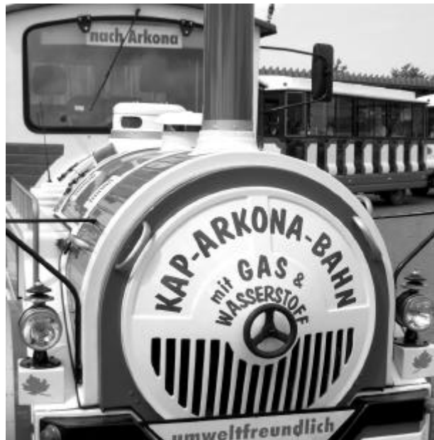
Wasserstoff versorgt die periphere Elektrik dieses Zuges der Arkonabahn Fotos: DWV
