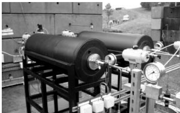
Die Vorratsspeicher der Freisetzungsanlage in Buxton (Auslass hinter der Mauer) Foto: DWV
