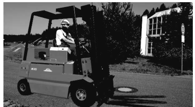
Gabelstapler mit PEM-Brennstoffzelle auf dem Gelände der SWB Foto: SWB
