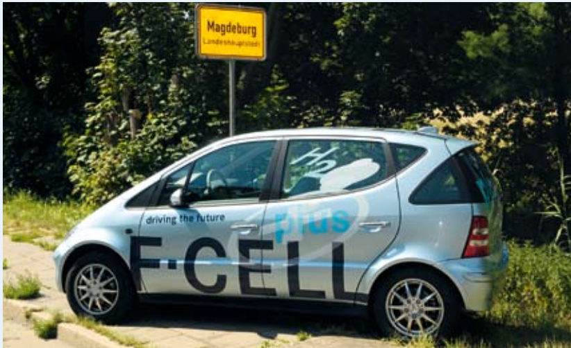
Angekommen – die erste längere Fahrt eines Brennstoffzellen-Daimler auf Basis der A-Klasse mit einem 700 bar-Tank auf öffentlichen Straßen führte von Berlin nach Magdeburg Quelle: Daimler
