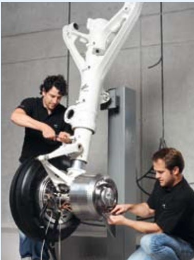
Arbeiten am elektrischen Antrieb des Bugrads bei der DLR Quelle: DLR
